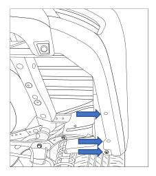
6. Remove 3x scrivet clips under the bumper.
